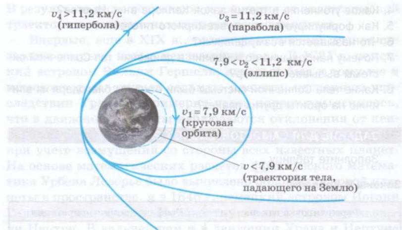
скорости, а не массы запускаемого тела, зависят форма траектории полета космического аппарата и возможность преодоления силы притяжения планеты или иного космического тела (рис. 2.39). Различают четыре космические
