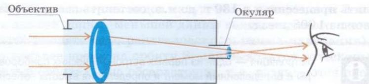
Схема телескопа Г. Галилея
